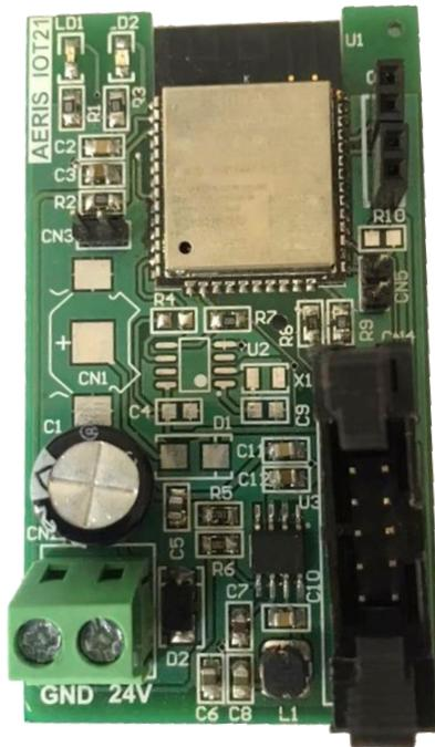
A nova linha de controlador wifi Aeris consiste de uma placa de processamento, denominada **C-IOM-WW** que pode ser conectada à diversas placas de expansão.
